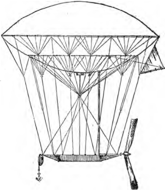
FIG. 15. — Ballon dirigeable de M. Dupuy de Lôme (deuxième idée; expérience du 2 février 1872).
